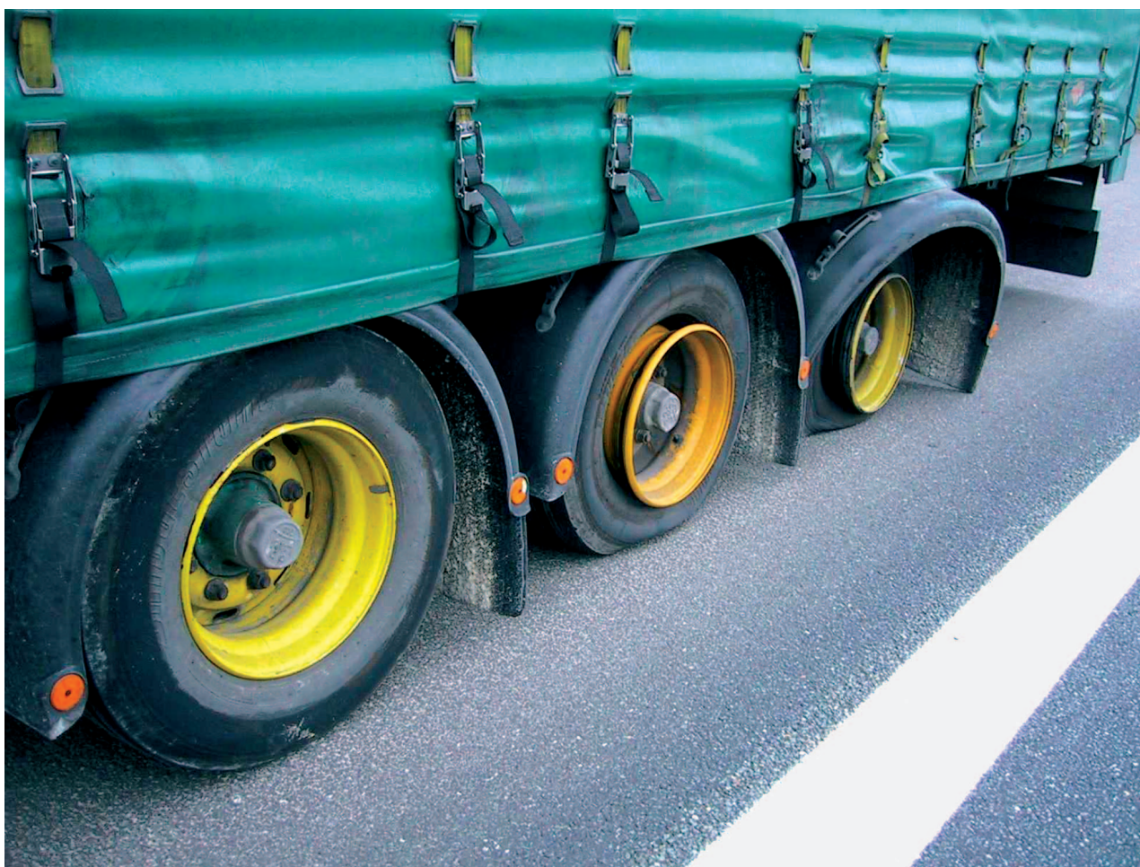
Platzt ein Reifen auf Grund von zu niedrigem Luftdruck, ist nicht nur der materielle Schaden groß: Verzögerungen in der Supply Chain können den Transportunternehmer auch sonst teuer zu stehen kommen.
